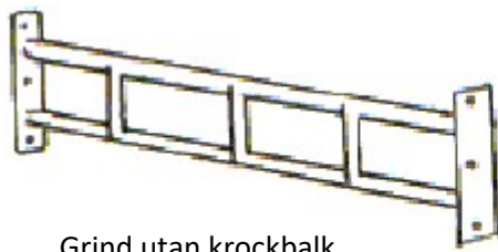
Grind utan krockbalk
